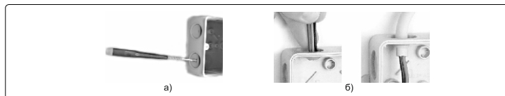
Рисунок 2 – Ввод кабеля в корпус Radio 8615 IP65
