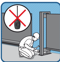
Lock and release of receiver during maintenance Verrouillage et déverrouillage de récepteur lors de l'entretien
