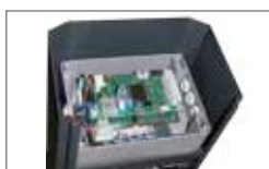
Electronic control unit positioned on the top of the carter Centrale électronique placée sur la partie supérieure du carter
